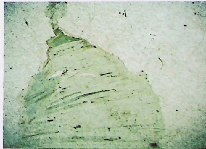
Fotomicrografia F – Mica verde clara, notar venulação na parte superior da foto. Amostra 09B. Luz plano polarizada. Lado maior da foto: 10,40 mm
