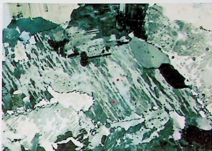
Fotomicrografia 2 – Granito Principal. Mesopertita com forte padrão de exsolução e bordas albíticas. Amostra GUA-18A. Polarizadores cruzados. Lado maior da foto: 3,25 mm
