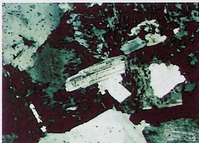
Fotomicrografia D – Granito Principal .Cristais de albita crescidos sobre pertita. Amostra GUA-02. Lado maior da foto: 3,25 mm
