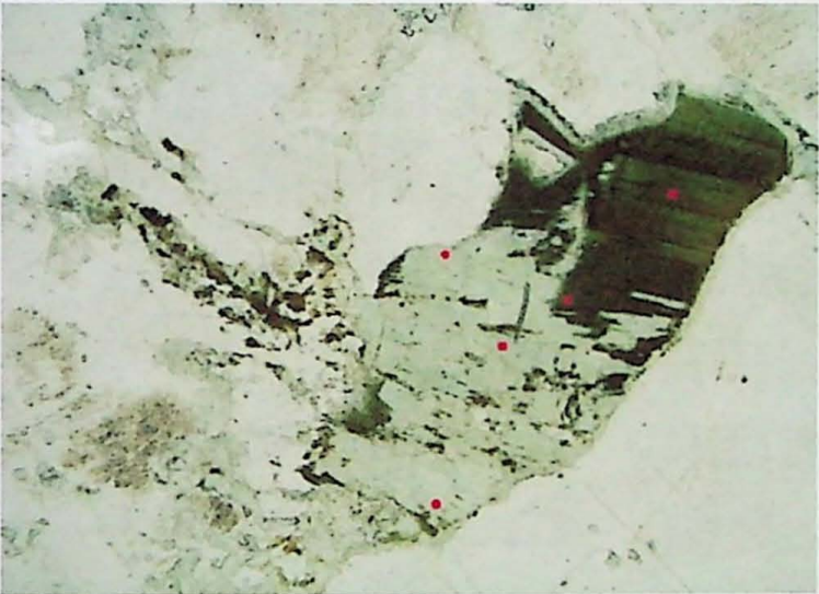
Fotomicrografia 3 – Granito principal. Notar aspecto pervasivo da alteração para zinwaldita. Amostra GUA 08C. Luz plano polarizada. Lado maior da foto: 3,25 mm
