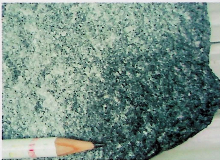
Foto J – Detalhe do contato do greisen (à direita). Observar concentração de minerais máficos no greisen e o contato nítido com o leuco granito cinza. Amostra 08B. Afloramento GUA - 08.
