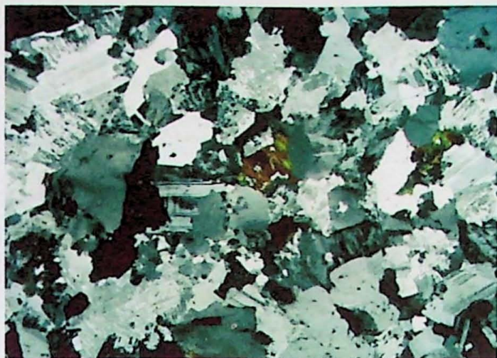
Fotomicrografia A – . Aspecto geral da textura equigranular hipidiomórfica do granito principal da Unidade Desembarque, notar baixo IC, e biotitas sendo cloritizadas. Amostra GUA-02. Polarizadores cruzados. Lado maior da foto: 8,32mm
