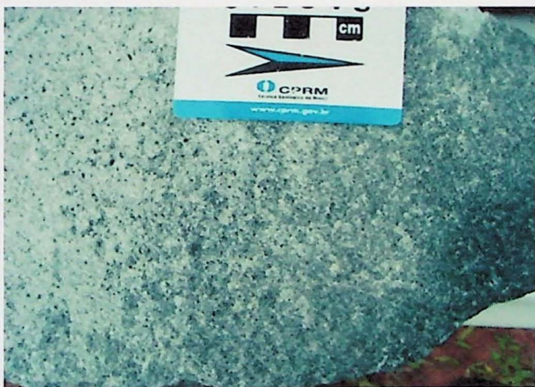
Foto I – Zona de contato entre o leuco granito cinza médio claro equigranular, de aspecto algo sacaróide ("aplitico"), com o greisen, mais escuro (à direita da imagem). Amostra 08B. Afloramento GUA 08
