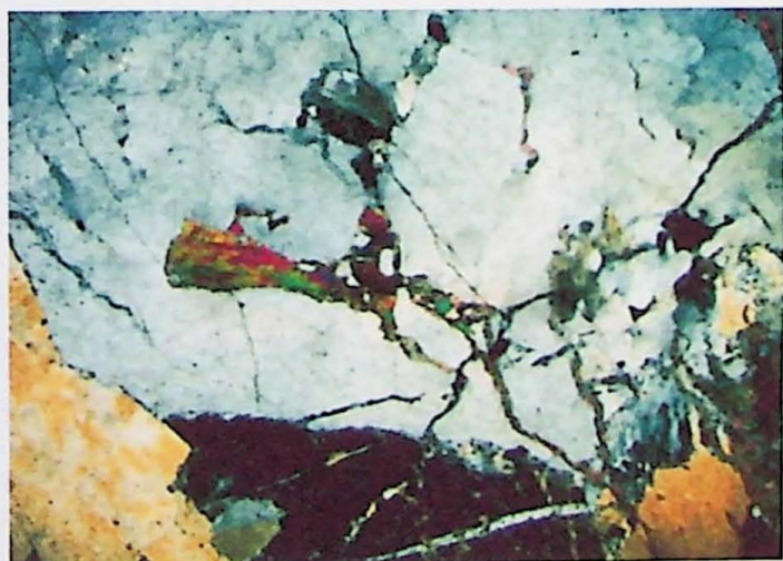
Fotomicrografia E – Megacristal de feldspato alcalino com alteração de mica verde nas fraturas do grão. Amostra 09B. Polarizadores cruzados. Lado maior da foto: 10,40 mm
