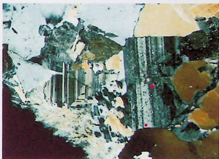
Fotomicrografia 4 – Granito Principal. Oligoclásio Sódico (An =17%) com borda de albita pura. Amostra GUA-09A. Polarizadores cruzados. Lado maior da foto: 3,25 mm
