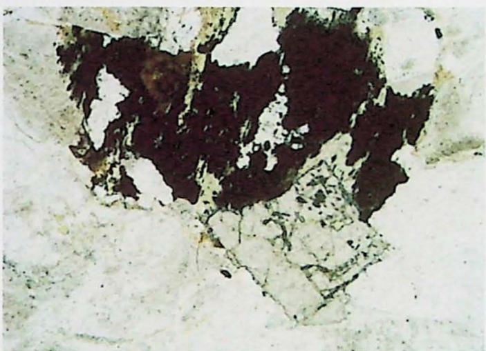
Fotomicrografia I – Aglomerado de opacos, fluorita e mica branca com allanita (cristal marrom na parte superior esquerda). Luz Plano Polarizada. Amostra GUA-02. Lado maior da foto: 1.63 mm
