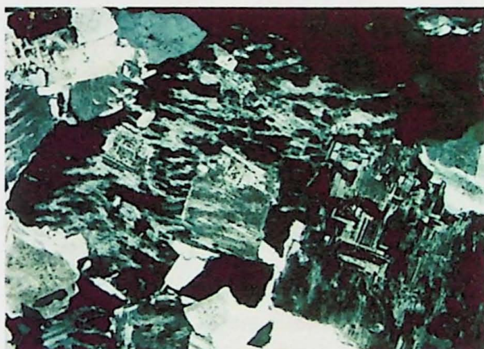
Fotomicrografia C – Granito Principal. Pertita com aspecto de manchas . Amostra GUA-02. Polarizadores cruzados. Lado maior da foto: 3,25mm
