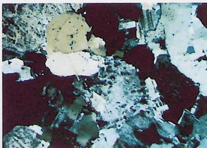
Fotomicrografia E – Granito Principal. Quartzo com extinção ondulante e albita na borda de grão de mesopertita. Polarizadores cruzados. Amostra GUA-02. Lado maior da foto: 3,25 mm
