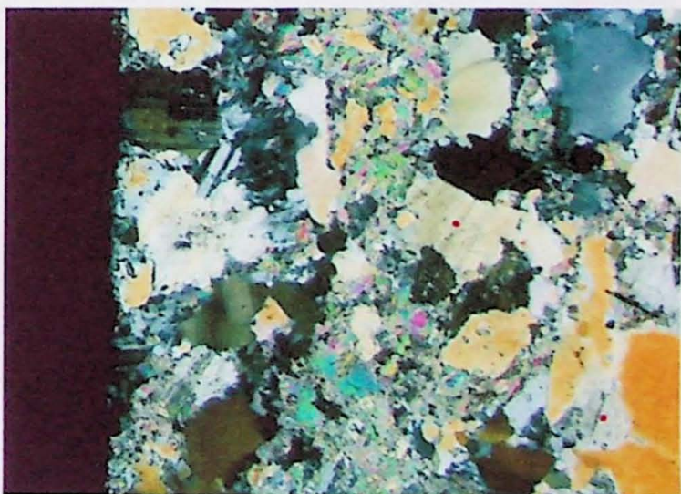
Fotomicrografia 6 – Albita granito. Destaque para considerável presença de cristais de albita pura. Amostra GUA-08B CLAR. Polarizadores cruzados. Lado maior da foto: 5,2 mm
