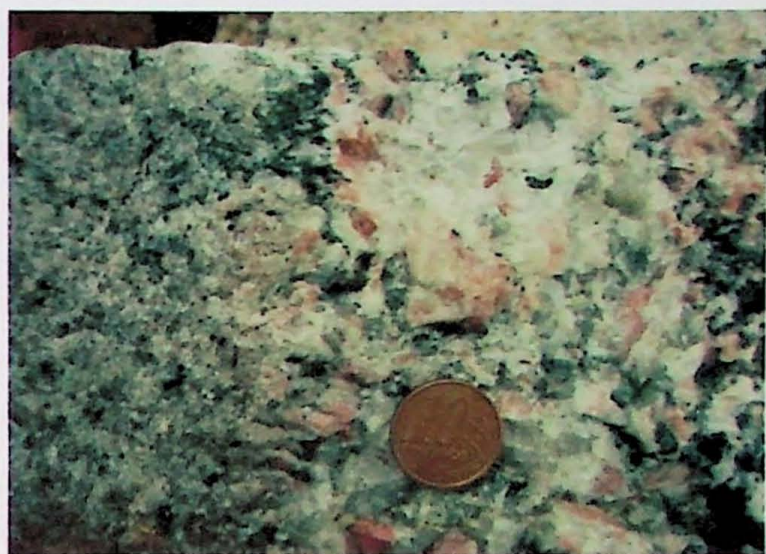
Foto H – Detalhe do contato entre o granito principal e bolsão pegmatítico. Observar concentração de biotita e a presença de zona feldspática com intercrescimento granofírico (a esquerda da moeda de referência). Amostra 09B.
